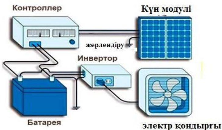
1.6 – сурет – Күн фотоэлектрстанциясының құрылымы
